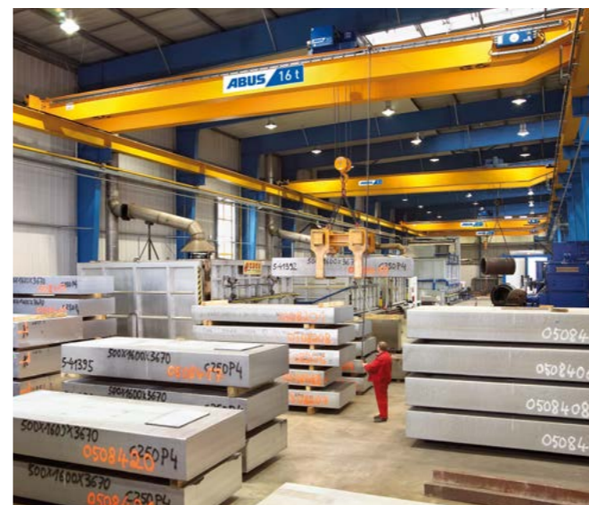
Overliggende løpekatter i byggeform D på todagerkraner.
