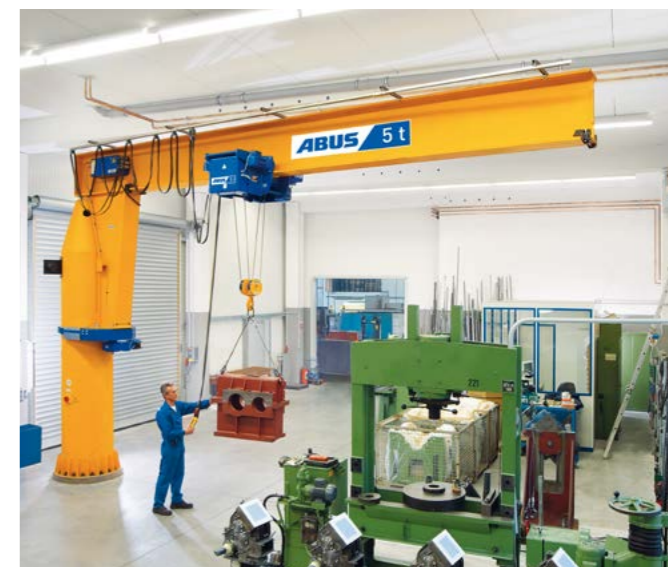
Enskinne løpekatt i byggeform E på en VS søylesvingkran.
