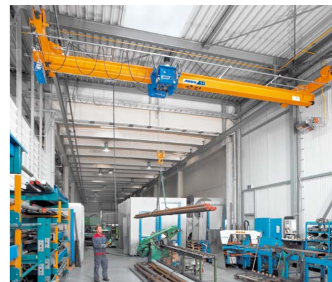
Enskinne løpekatt i byggeform E, her på en EDL henge-traverskran.
