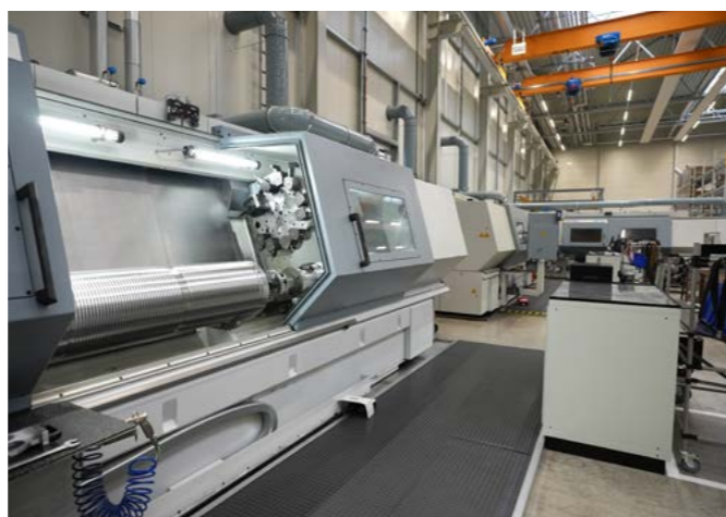
Wiretromlene maskineres i moderne CNC-maskiner i én oppspenning. Dette garanterer feilfrie tromler uten radialkast.
