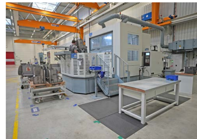
CNC maskinering av wireheisverkets 4-akse fresesentre
