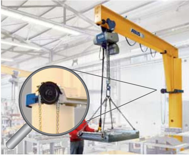
Mekanisk svingbrems (bilde 9)
